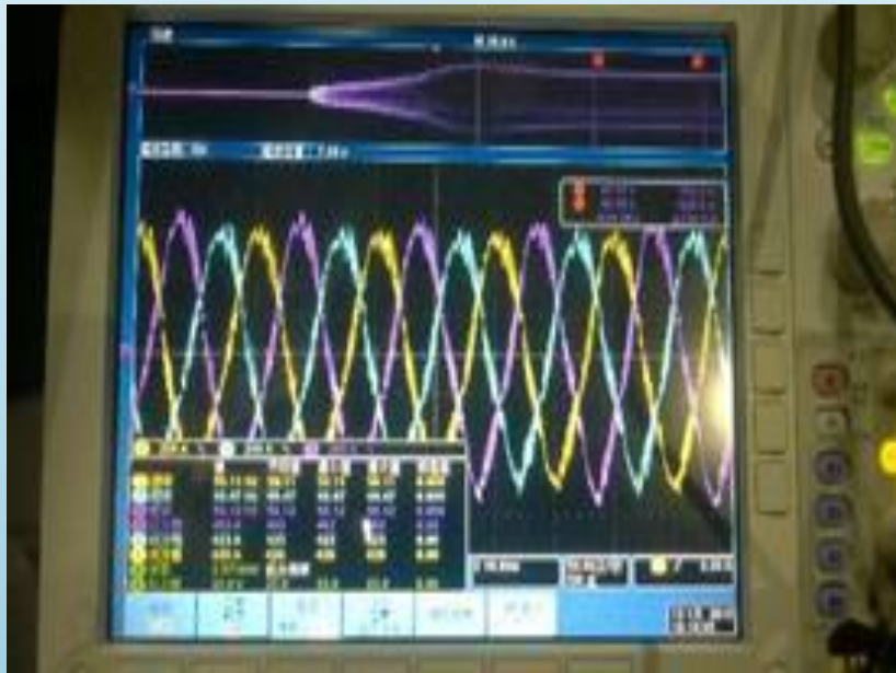
未發生喘震時的電流波型
